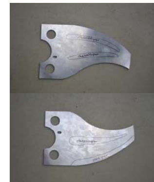
Kuttermesser für die Lebensmittelindustrie mit angezeigten Härtespurverlauf
