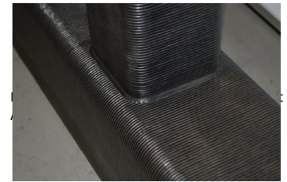
Mittels WAAM gefertigtes musterbauteil mit Anschlusssegment
