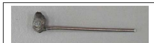
Abbildung 29: Kugelbildung am Zusatzwerkstoff beim Laserstrahlschweißen
