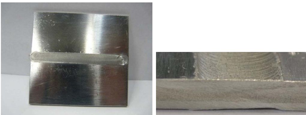
Abbildung 50: Beidseitig geschweißtes ungeschäumtes AFS
