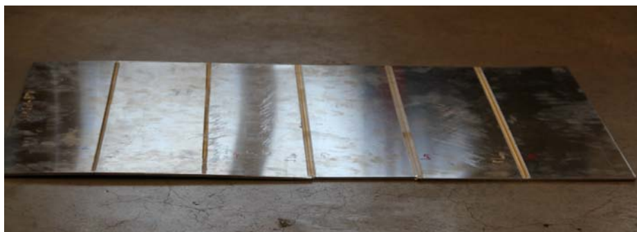
Abbildung 49: Einseitig rührreibgeschweißte ungeschäumte AFS
