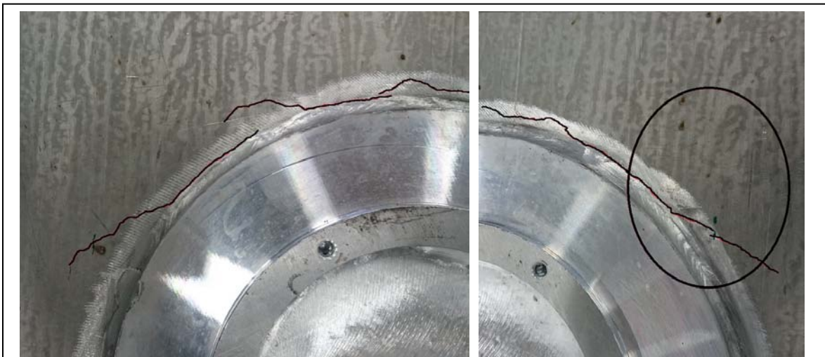
Abbildung 124: Rissverlauf im Demonstrator
