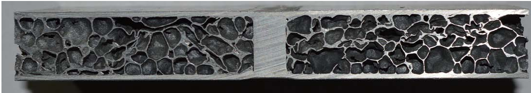
Abbildung 53: Rührreibschweißnaht mit Inlay an geschäumten AFS
