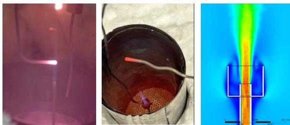
**Herausforderung:** Einer der entscheidenden Prozesse zur Einbettung der Brennstoffzelle in den Gasturbinen-Kreisprozess ist die Nachoxidierung des Anodenabgases (eine Mischung aus  $\text{H}_2/\text{CO}/\text{CO}_2/\text{H}_2\text{O}$ ), das durch eine hohe Temperatur (ca.  $800\text{ °C}$ ) und einen hohen Anteil an
