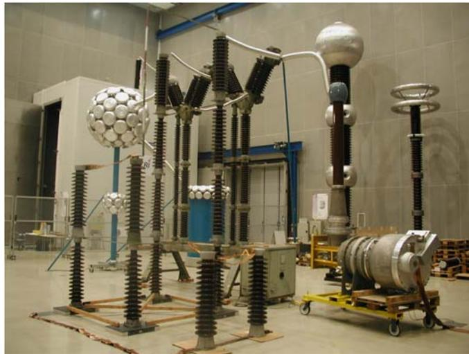
Abb. 20: Kippschwingungsversuche am GIS-Spannungswandler
