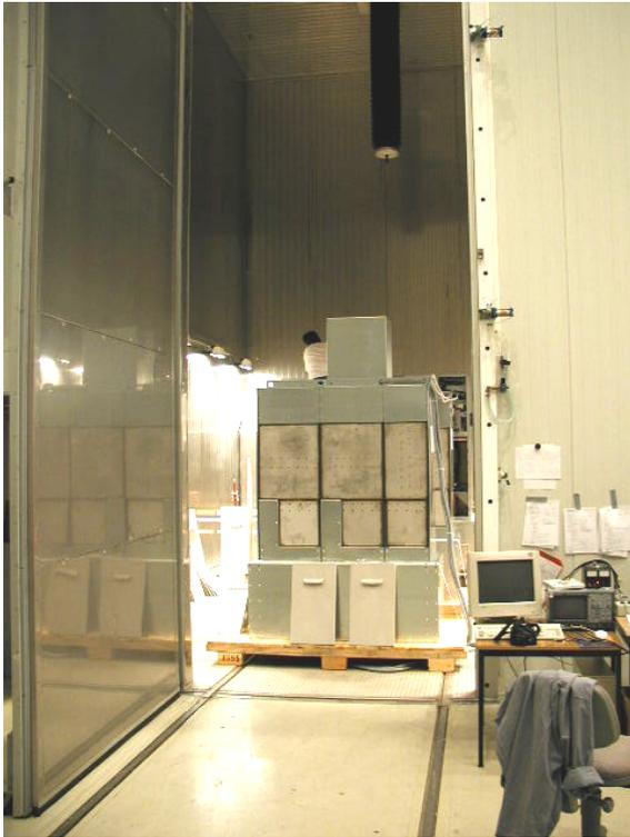
*Abb. 5: Mittelspannungsschaltanlagen in der Klimakammer vor der Alterung*
