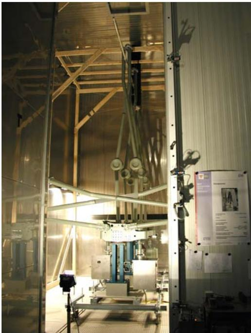
*Abb. 15: Vier 420 kV-Scherentrennschalter in der Klimakammer*
