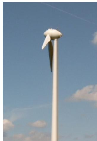
*Abb. 24: durch Gewitterentladung geschädigte WKA*
