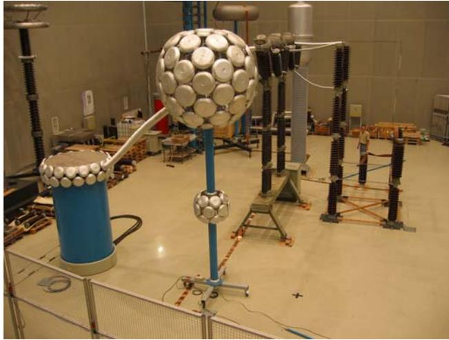
*Abb. 19: Kippschwingungsversuche am 420 kV-Kombiwandler*
