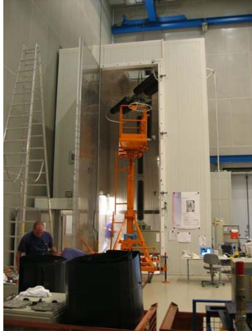
*Abb. 11: Klimakammer im Hochspannungsprüffeld beim Aufbau eines 550 kV-Leistungsschalter*
