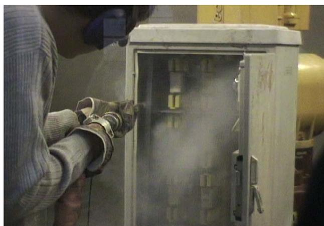
*Abb. 7: Vorversuch zum Trockeneisreinigen elektrischer Anlagen*
