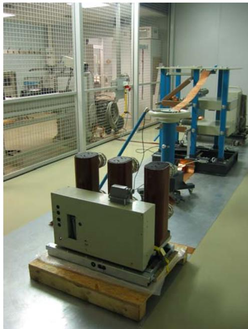
*Abb. 14: Mittelspannungsleistungsschalter bei der Blitzstoßspannungsprüfung*
