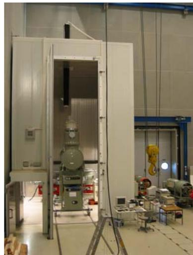
*Abb. 13: einpoliger Innenraumleistungsschalter und dreipoliger gasisolierter Trennschalter*
