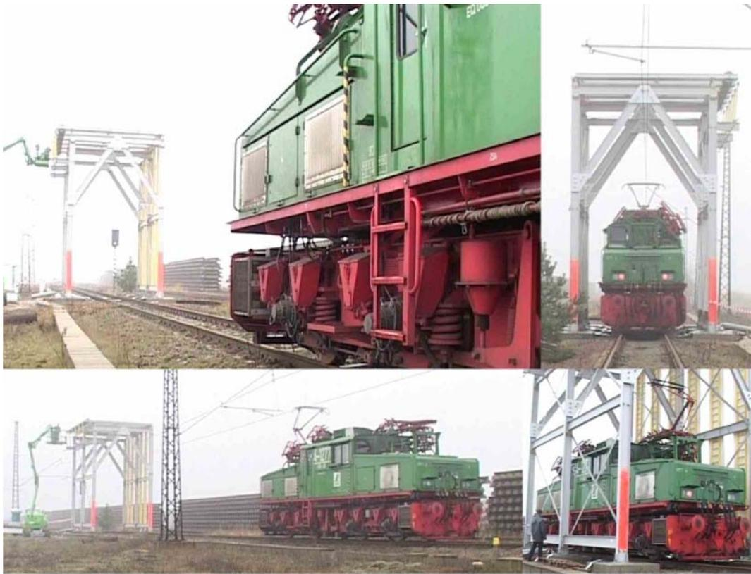
Abb. 2: Störfestigkeitstest an einer modernisierten Industrielokomotive
