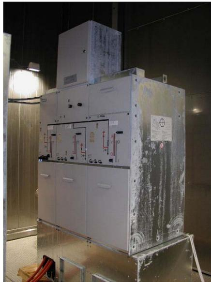
*Abb. 23: Mittelspannungsschaltanlage während der Alterungsprüfung*
