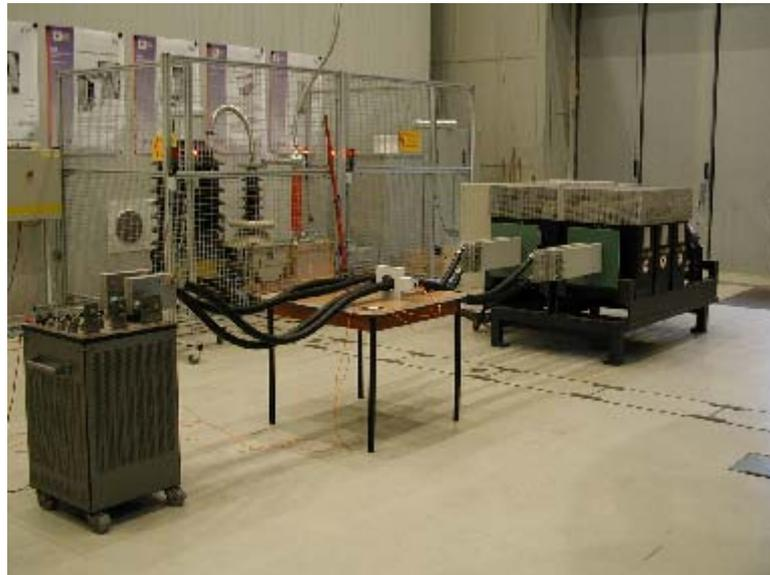
*Abb. 17: Versuchsaufbau zur Bestimmung der Linearität des optischen Stromwandlers (v.l.n.r.: Referenzwandler, optischer Stromwandler (auf dem Tisch), Hochstromanlage)*
