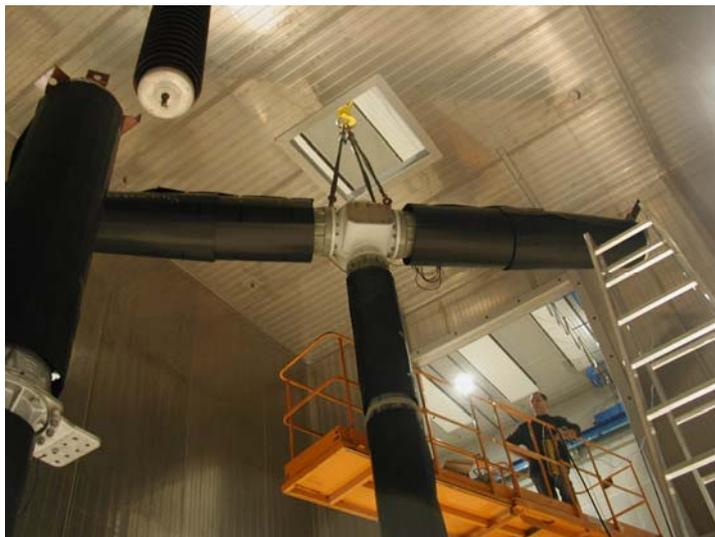
*Abb. 26: Einbau eines Hochspannungsschalters in die Klimakammer*
