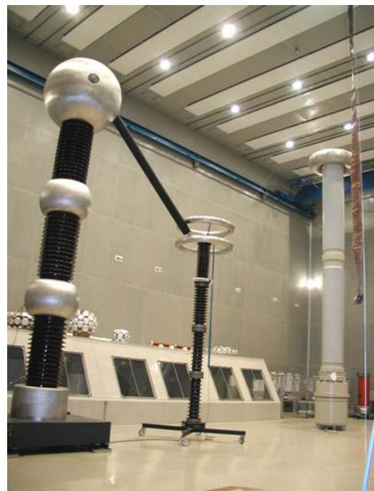
*Abb. 30: Gleichspannungskaskade mit Prüfaufbau GiS - Schottisolator*
