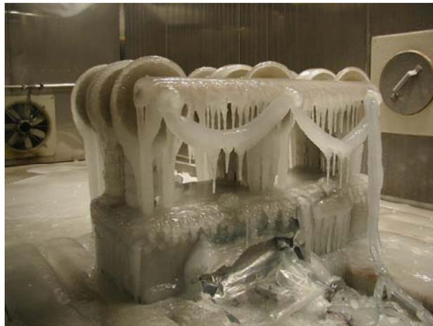
*Abb. 25: Vereister Mittelspannungs-Freileitungsschalter*
