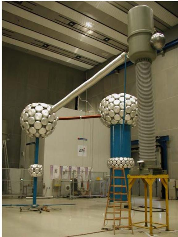
Abb. 8: Teilentladungsmessung an einem Kombiwandler
