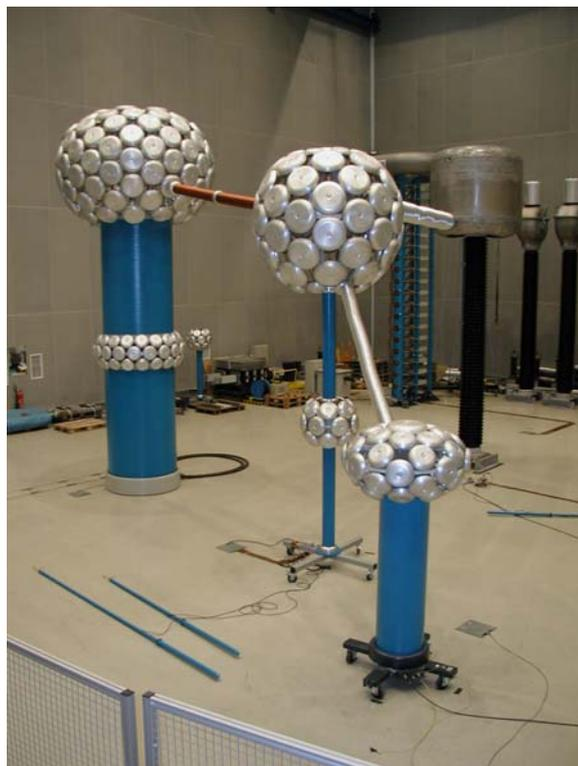
Abb. 7: Kapazitätsmessung an einem Stromwandler
