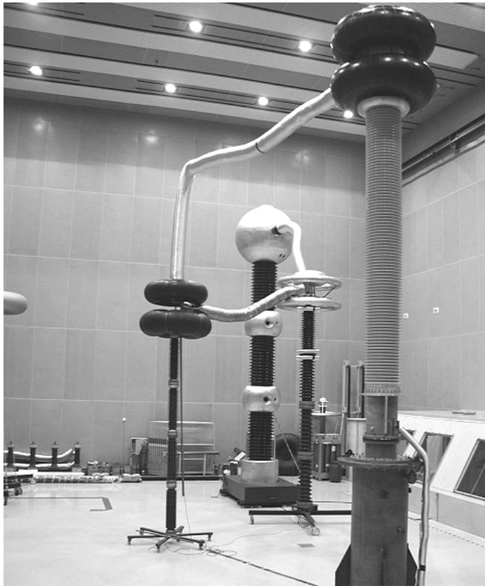
*Abbildung 8: Versuchsaufbau DC-Prüfung der Durchführungen*
