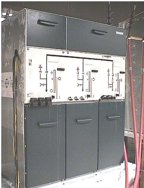
*Abbildung 15: Eine MS-Lasttrennschalteranlage nach der Klimaprüfung*
