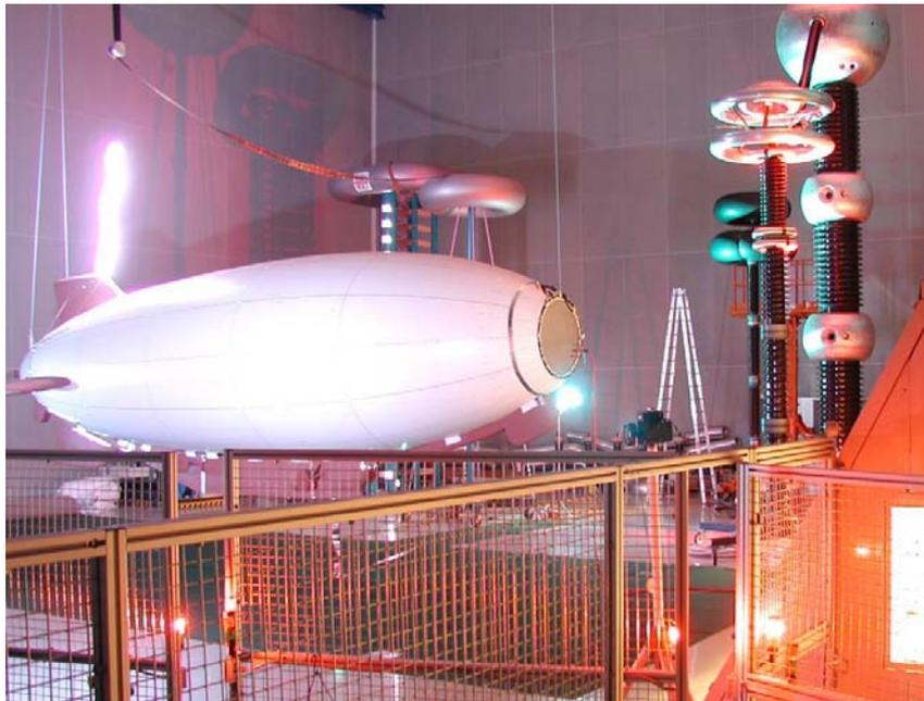
*Abbildung 14: Modell des CargoLifter im Maßstab 1:25 mit Überschlag am Heck in der Hochspannungshalle der BTU*
