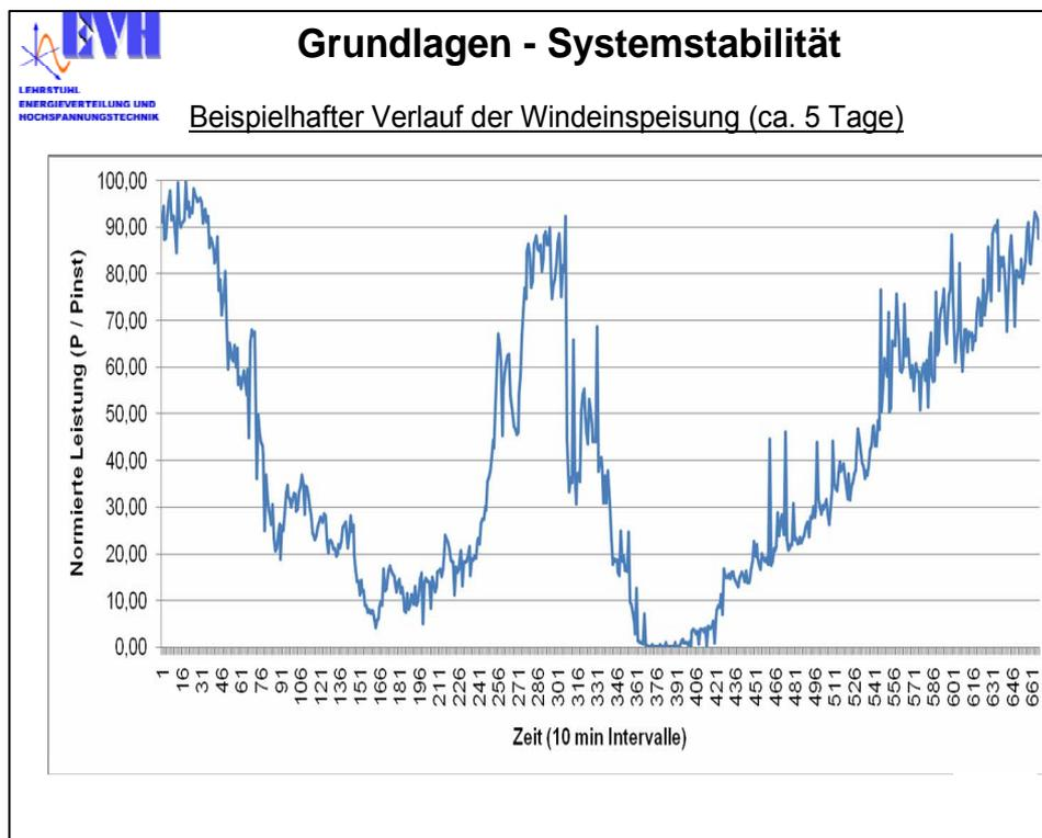
Abbildung 3.1 Beispielhafter Verlauf der Windeinspeisung einer Einzelanlage
