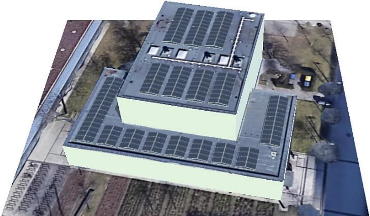
Bild 8a: Exemplarische Belegung des Dachbereiches des Großen Hörsaal Gebäudes mit PV in Ost / West Ausrichtung. In ähnlicher Form wurden die Dächer aller BTU-Gebäude auf dem Zentralcampus untersucht
