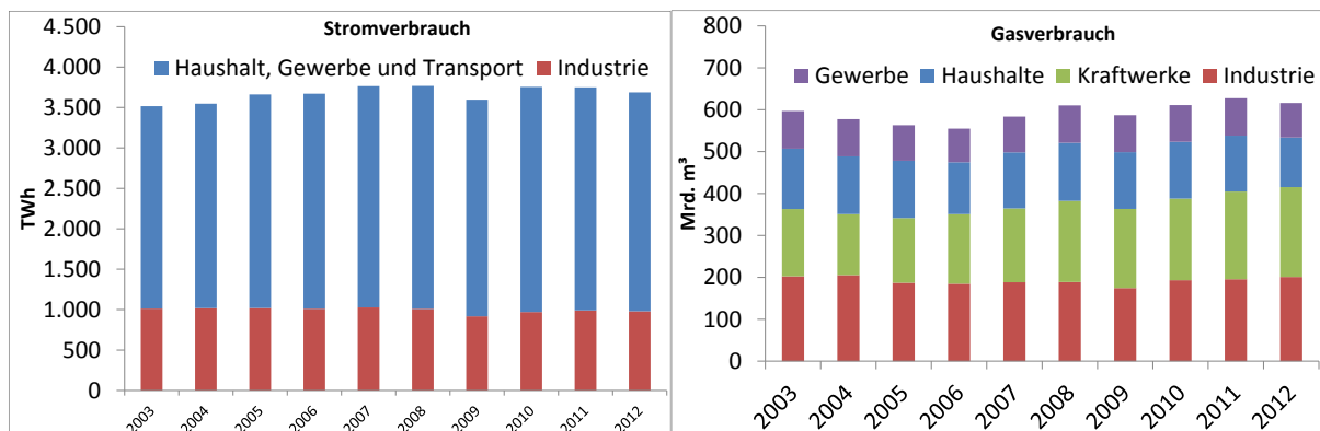
Abbildung 1.11: Aufteilung des Stromverbrauchs (links) und Gasverbrauchs (rechts) in den USA
