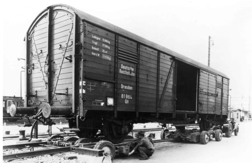
Abb. 4 Auf einem Culemeyer-Straßenfahrzeug aufgebockter gedeckter Güterwagen (Bildarchiv DB-Museum Nürnberg)
