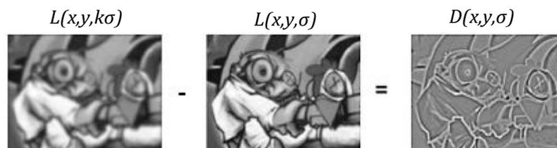
**Abbildung 3-35:** Approximation von Laplace durch die Differenz zweier Gauß-geglättete Bilder [Tuy08 S. 247]
