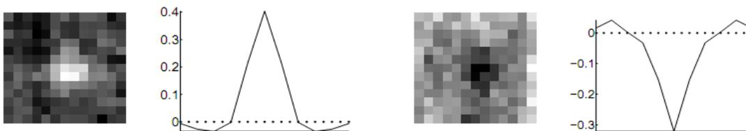
**Abbildung 3-31:** non-maximal suppression beim Star-Detektor [Kie07 S. 207]
