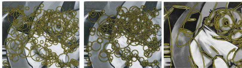
**Abbildung 3-19:** Detektion interessanter Bildregionen durch SIFT (links), SURF (Mitte) und MSER (rechts) [Tuy08]
