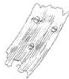
Abb. 4: Sicherung der Holznägel durch Gegenkeile
