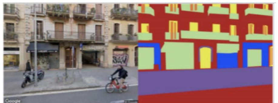
Abb. 2: Anwendungsbeispiel KI-Software zur Analyse von Fassadenmaterial
