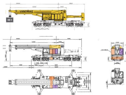
Abb. 2: Kran V – Vanomag, zusätzlicher nutzbarer Raum
