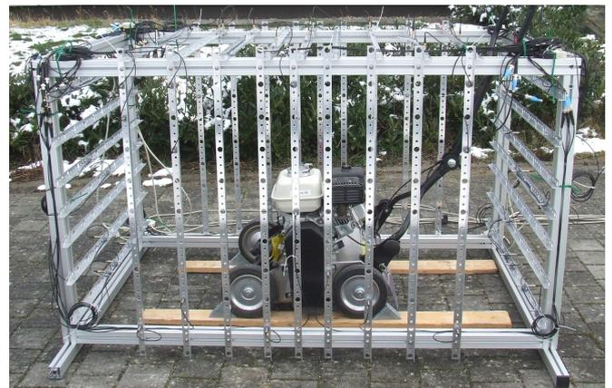
Abbildung 1: Benzinvertikutierer mit dem ihn umschließenden Mikrofonarray (insgesamt 68 Mikrofone).
