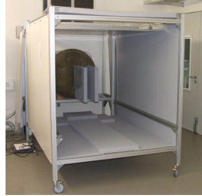
Abbildung 1: Messraum des aeroakustischen Windkanals mit mobiler schallabsorbierender Kabine.
