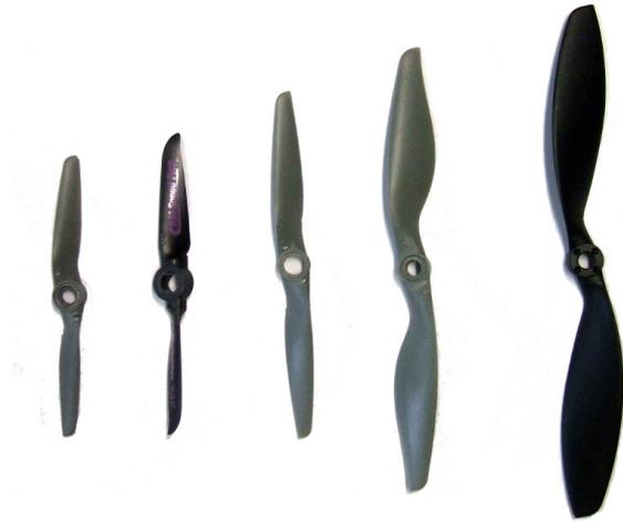
**Bild 2:** Verwendete Propeller (von links nach rechts: APC E 4,5" × 4,1", CAM Speed Prop 4,7" × 4,7", APC E 5,5" × 4,5", APC E 7" × 6", AEJ Slowfly 8" × 6")
