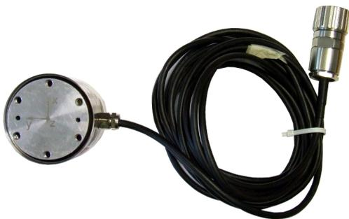
**Bild 4:** Verwendeter Sechs-Komponenten-Sensor K6D40
