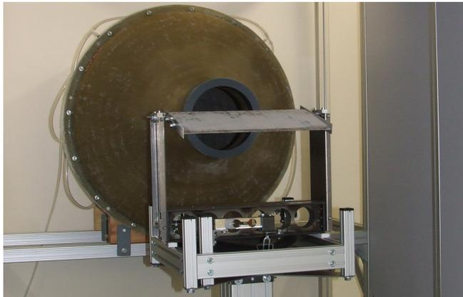
Bild 4: Windkanal der BTU mit Düse und Profil
