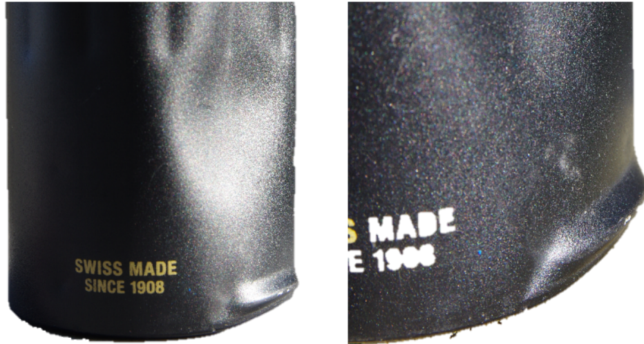
[Bild: Elefantenfußbeulen einer Stahlflasche, Wolfgang Dornisch]
