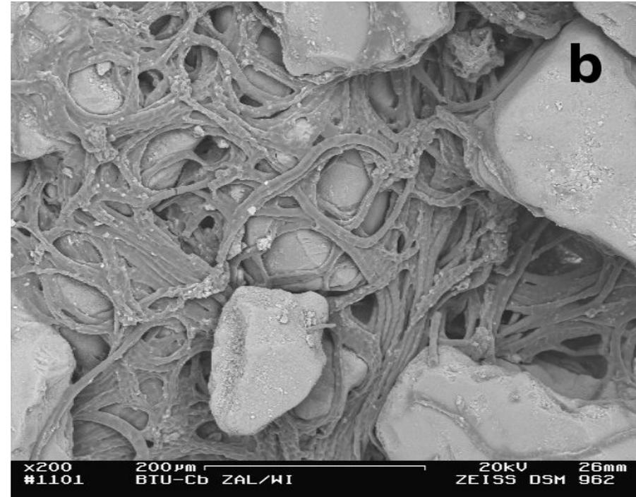
Algenfilamente füllen die Matrixporen teilweise aus,
