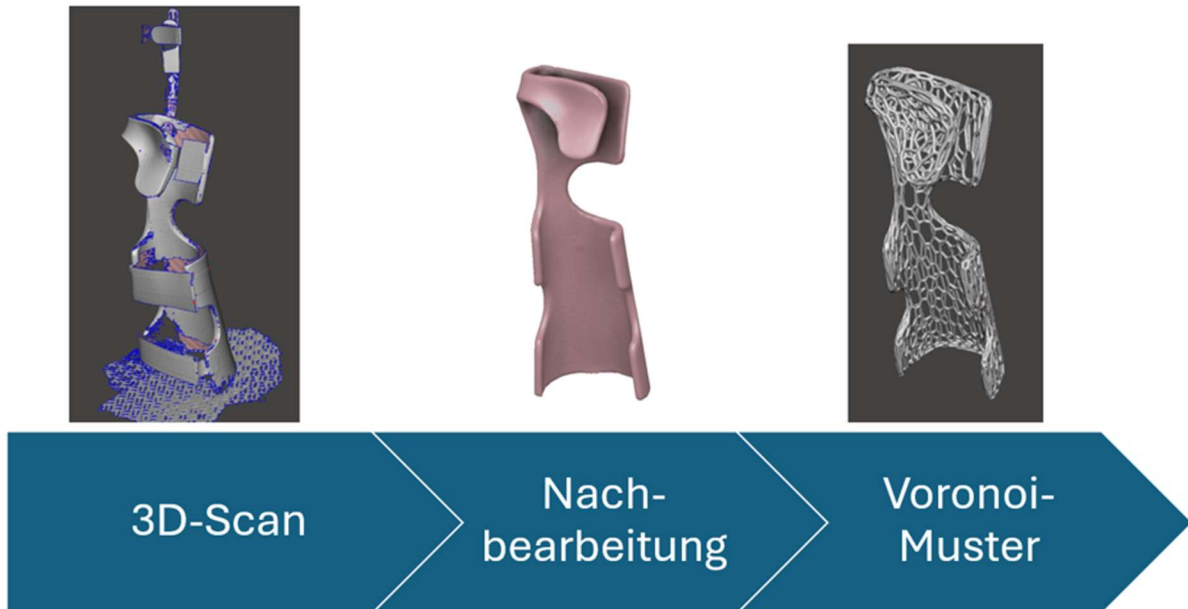
Abbildung 3: Prozesskette - 3D-Scan, parametrische Modellanpassung, Voronoi-Muster Erstellung
