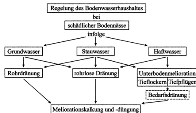
Abbildung 3-36: Moderne Dränmethoden in Abhängigkeit von der Ursache der Bodenvernässung [EGGELSMANN, 1981]
