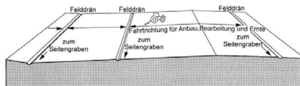
parallele Anordnung der Elemente einer Oberflächenentwässerung (nach SEVENHUIJSEN [1994])
