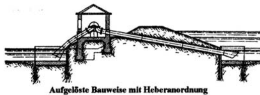
Aufgelöste Bauweise mit Heberanordnung
