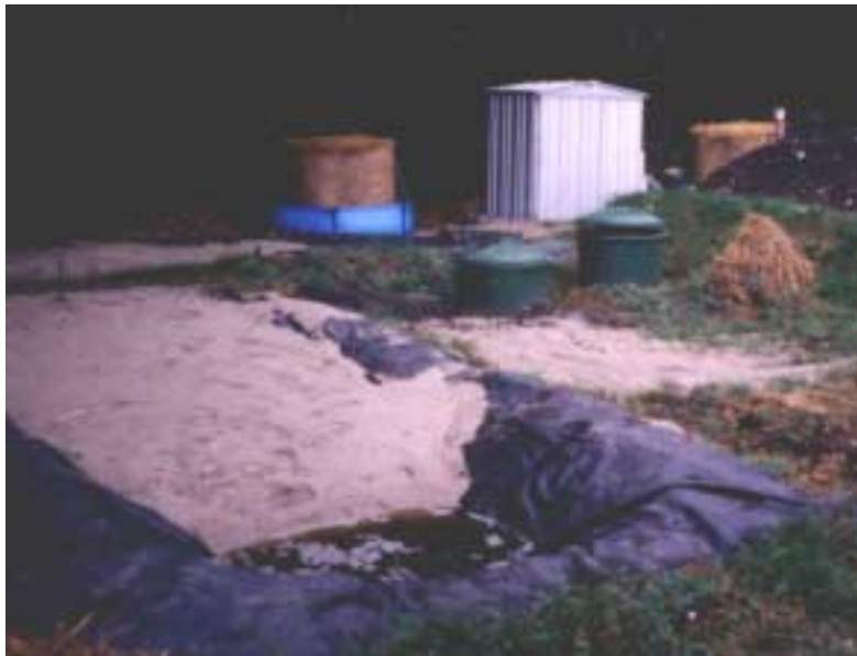
Abbildung 3.25 Denitrifikationsreaktoren in der zweiten Versuchsphase
