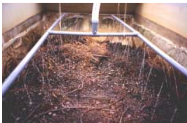
Abbildung 4.22 Beregnungseinrichtung des als Rieselfilter betriebenen Adsorptionsreaktors
