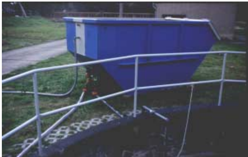
Abbildung 4.5 Absetzmulde, umgebaut zum Adsorptionsreaktor
