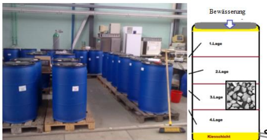
Abb. 1.3-15: Links: Anordnung der Fässer mit unterschiedlichen Zuschlägen (Fassversuche). Rechts: Schematischer Schnitt durch einen Versuchsbehälter mit in 4 Lagen verdichteten Materialgemischen.
