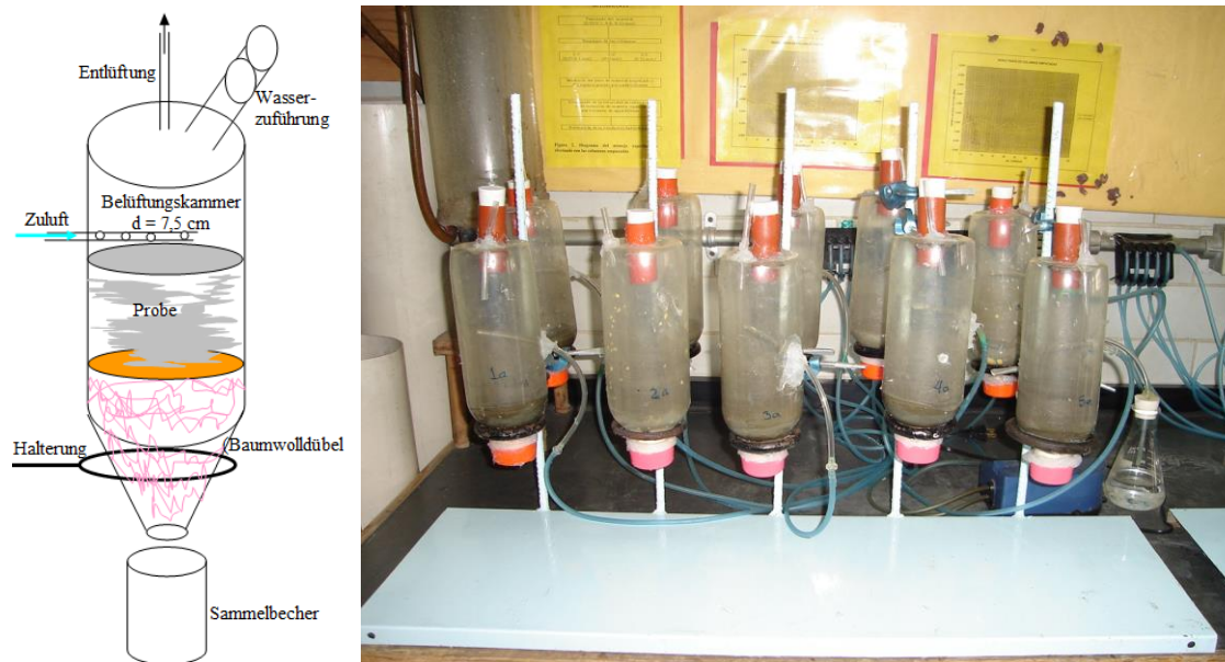
Abb. 3.5-2: Feuchtzellensystem von GONZÁLEZ SANDOVAL* (2006).
