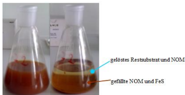
Abb. 3.1-7: Grundwasserprobe im Prozess mikrobieller Sulfatreduktion nach Eisenhydroxidfällung (links) und Sedimentation (rechts).
