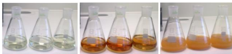
Abb. 3.1-5: Eisenbelastete Grundwasserproben vor- und nach der Wasserstoffperoxidzugabe sowie nach der Titration (von links nach rechts).
