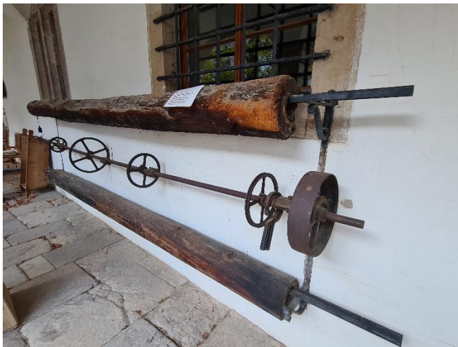
Abb. 4.2: Mittelalterliche Holzröhre und Röhrenbohrer im Schloss Tenneberg
