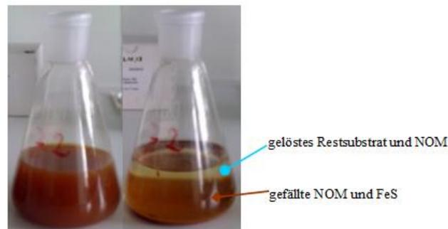
Abb. 3.2-2: Vorbehandelte Grundwasserprobe nach Eisenhydroxidfällung und Sedimentation mit der Lokalisierung zehrender Stoffe.
