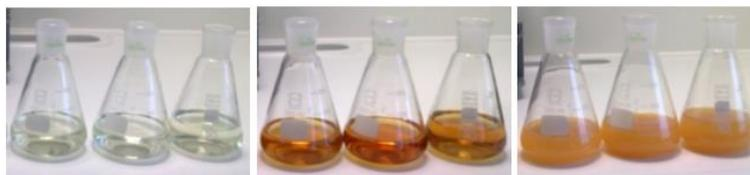
Abb. 3.2-1: Eisenbelastete Grundwasserproben vor- und nach der Wasserstoffperoxidzugabe sowie nach der Titration (von links nach rechts)
