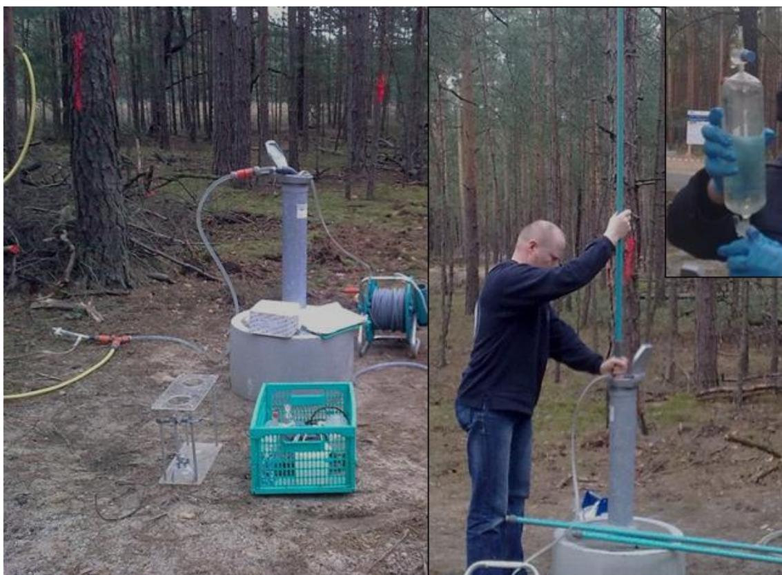
Abb. 3.4-1: Wasserprobenahme und Tracerbeprobung mit Gasmaus (rechts oben)
