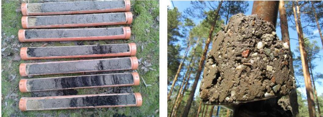
Abb. 4.1-1: Beispiele der im Versuchsgebiet erbohrten Sedimente. Linerproben vom FB3 (links) und Geschiebe aus dem Bereich der Anstrommessstellen (P0\*, 6439) (rechts).
