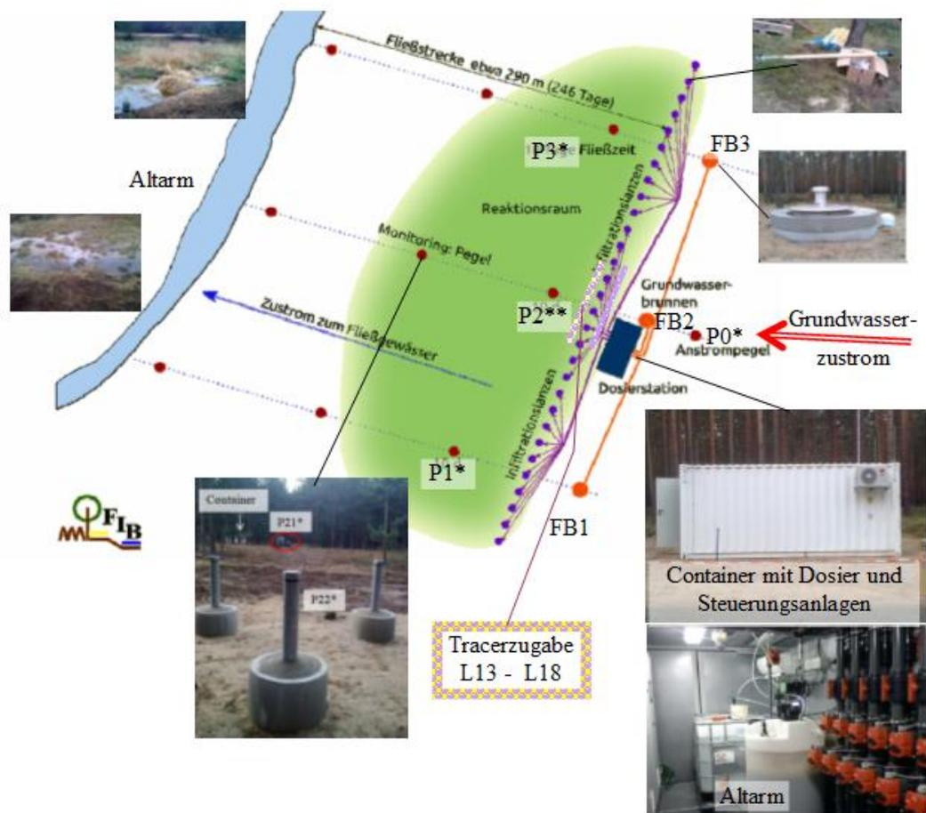
Abb. 4.5-1: Versuchsanlagen (Entwurfs- und Genehmigungsplanug LUG 2013 und WALKO et al. 2013). Die für die Tracerinfiltration eingesetzten Infiltrationslanzen sind mit einem violett gemusterten Strich markiert.
