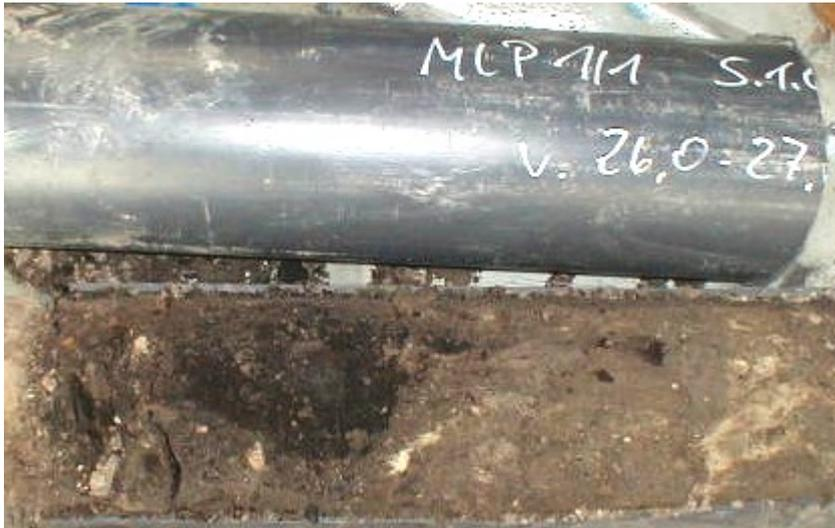
Abb. 5-2: Aufgesägter Liner aus dem Geschiebemergel des MLP1
