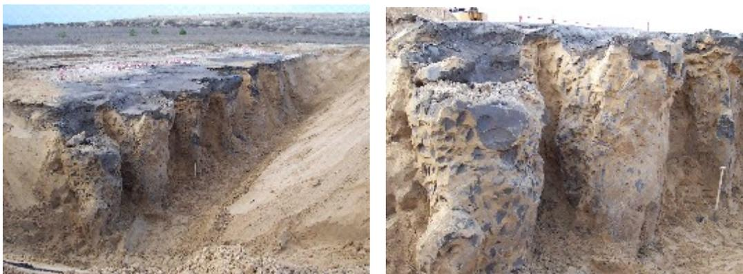
Abb. 2-2: Versuchsfeld der BUL Sachsen GmbH, Säulen bis 5 m unter GOK freigelegt (links) mit Aschesäulen der Aschesuspension  $1,6 \text{ t/m}^3$  (rechts)
