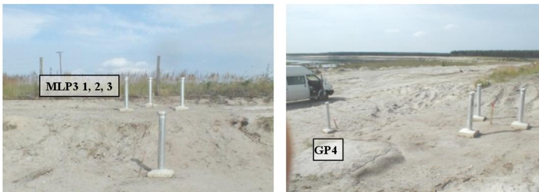
Abb. 4-7: Grundwassermessstellen hinter dem Wandabschnitt 3
