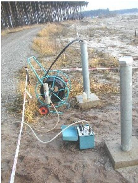
Abb. 4-10: Beprobung eines Pegels mit der Membranpumpe
