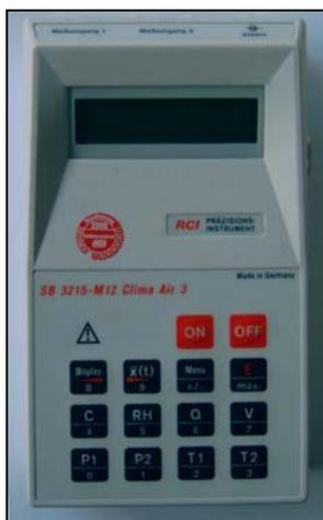
Bild 4.5: Messgerät Clima Air 3 (Foto)
