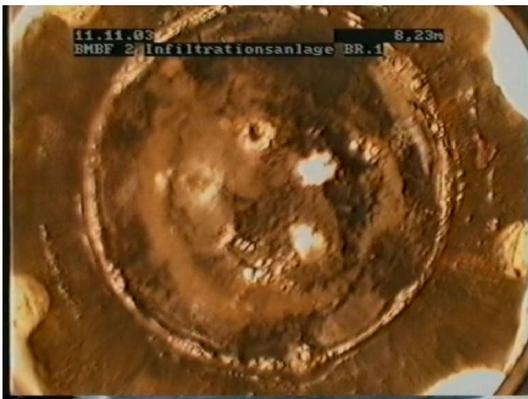
Wasserspiegel mit dichter Eisenhydroxidschicht
