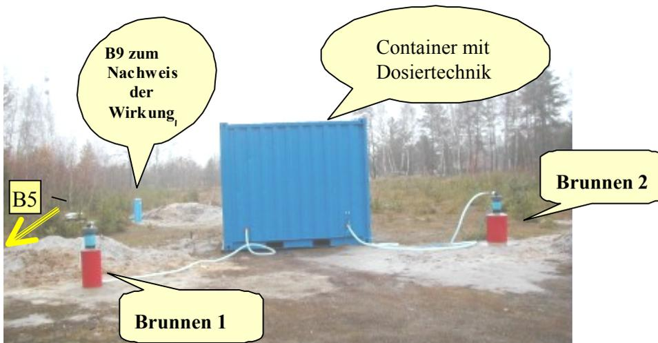
Abb. 4-13: Versuchsanlage mit Blick in Grundwasserfließrichtung (noch ohne Zaun)
