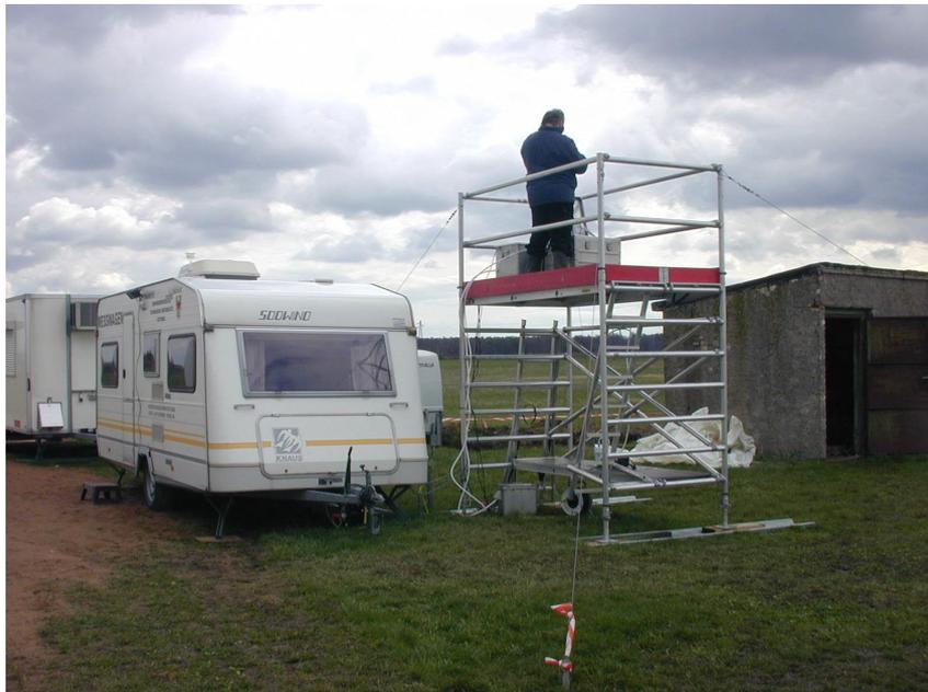
Bild 29: Mobiler Meßwagen der BTU-Cottbus auf dem Meßfeld in Melpitz; daneben Meßplatz für Vergleichsmeßsystem vom IfT Leipzig (im Aufbau)
