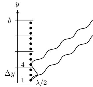
Abbildung 4: Dargestellt sind 12 im Bereich  $b$  dicht liegende Quellen. Löschen sich, wie dargestellt, die Wellen der 1. und der 4. Quelle aus, gilt dies gleichermaßen für die 2. und die 5., die 3. und die 6. und weiter für die 7. und die 10. und so weiter, so dass sich alle Wellen auslöschen. Der Abstand der Quellen 1 und 4 beträgt gerade  $\Delta y = b/4$ . Der gesamte Bereich ist demzufolge geradzahlig in 4 Teilbereiche unterteilt worden.
