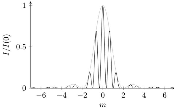
Abbildung 6: Intensitätsverteilung für zwei endlich breite Spalte. Dargestellt ist die Verteilung für  $d = 3b$ . Hier fällt beispielsweise das erste Minimum des Einzelspaltes gerade auf das dritte Maximum des Doppelspaltes, welches dadurch unterdrückt wird.
