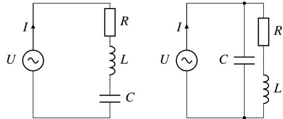
Abbildung 2: Reihen- und Parallelschwingkreis
