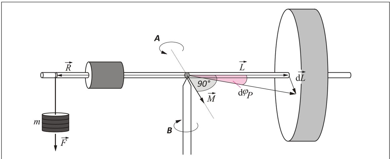
**Bild 2:** Zur Erklärung der Präzession eines Kreisels
