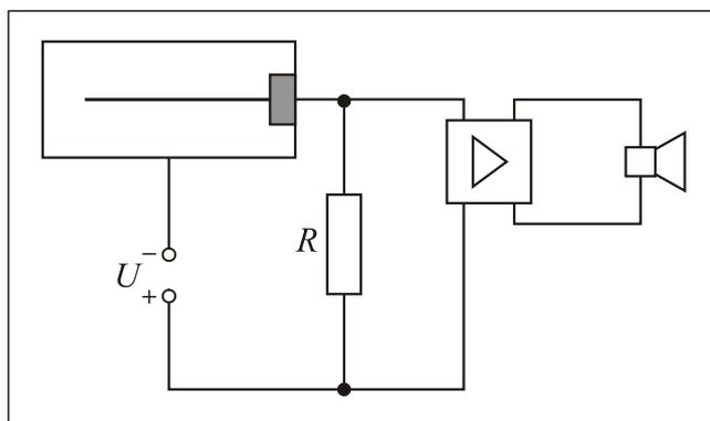
**Bild 1:** Schaltung Geiger-Müller-Zählrohr
