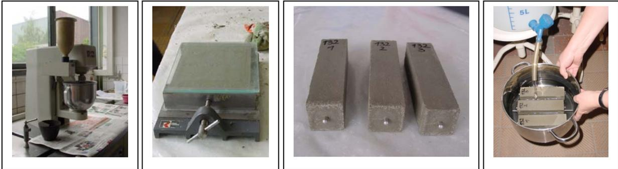
Die Längenmessungen erfolgen am 1., 4. oder 5., 8. oder 9. und 13. Tag nach der Nullmessung. Die Dehnung (Längenänderung) wird ins Verhältnis zur Prismenlänge gesetzt. Ausschlaggebend ist der Mittelwert der Messwerte aus 3 Proben nach 13 Tagen. Auftretende Risse und Abplatzungen sind zu dokumentieren.
