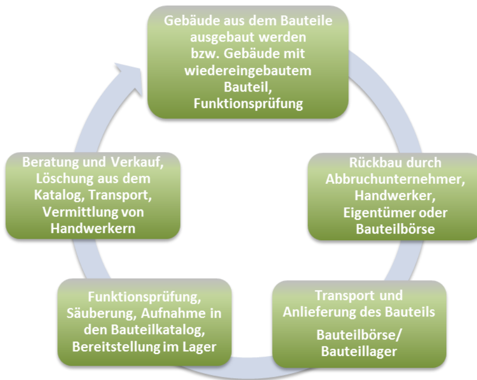
Abbildung 7: Arbeitsabläufe in Bezug auf die Bauteile-Wiederverwendung unter Beteiligung einer Bauteilbörse
