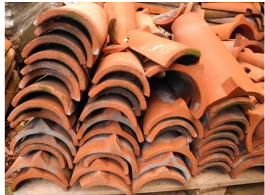
Abbildung 16: Firstpfannen für die Wiederverwendung
