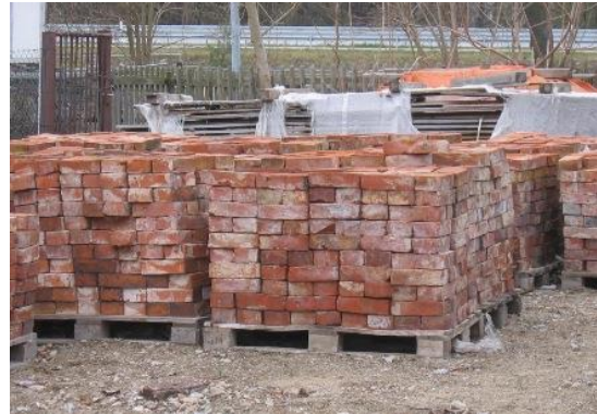
Abbildung 18: Mauersteine für die Wiederverwendung
