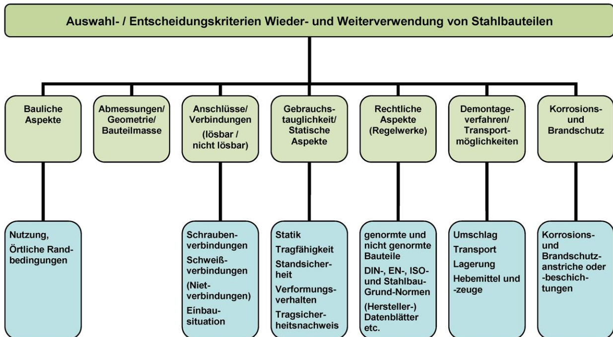
Abbildung 34: Auswahl-/Entscheidungskriterien zur Wieder-/Weiterverwendung von Stahlbauteilen
