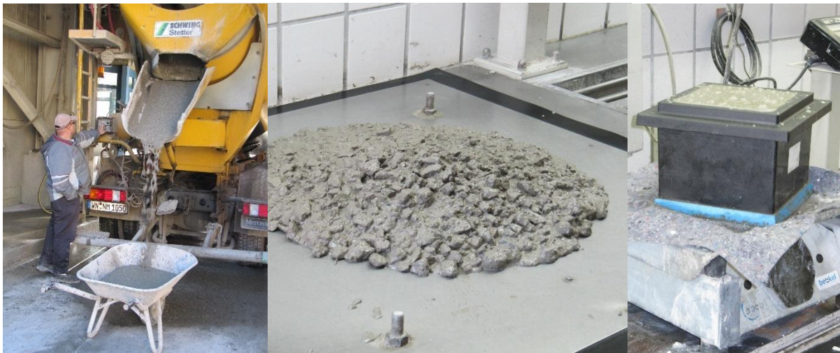
Abbildung 13: Probenahme aus der laufenden Produktion (links), Bestimmung des Ausbreitmaßes (Mitte), Herstellung von Probekörpern zur Bestimmung der Druckfestigkeit (rechts) [Foto: Mettke, 14.01.16,]
