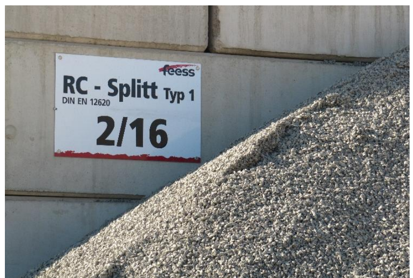
Abbildung 8: Rezyklierte Gesteinskörnung Liefertyp 1 [Aufnahme vom 10.11.2015, Mettke]
