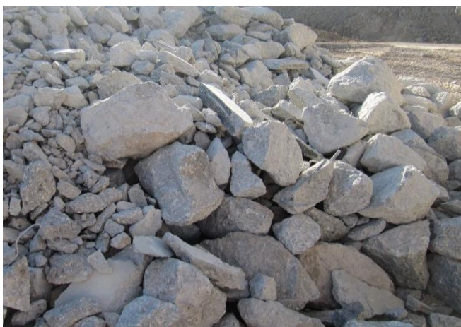
Abbildung 6: sortenreiner Betonbruch [Foto: Mettke, 10.11.2015]
