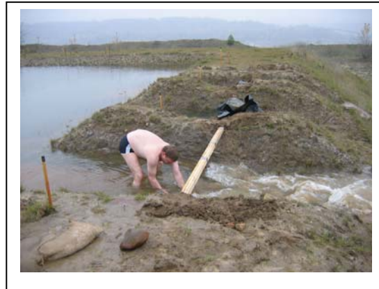
Abb. 300 : Beseitigung des Sandsackwalls für den Überströmversuch an der Überlaufstrecke Var. 3.1 mit 40 cm Überstau
