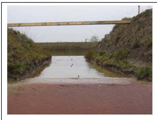
Abb. 302 : Überlaufrinne im Kronenbereich nach Überströmung der Überlaufstrecke Var. 3.1 mit 40 cm Überstau
