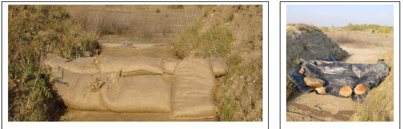
Abb. 295 : Sandsackwall für den Überstau von 20 cm der 1. Versuchsreihe
