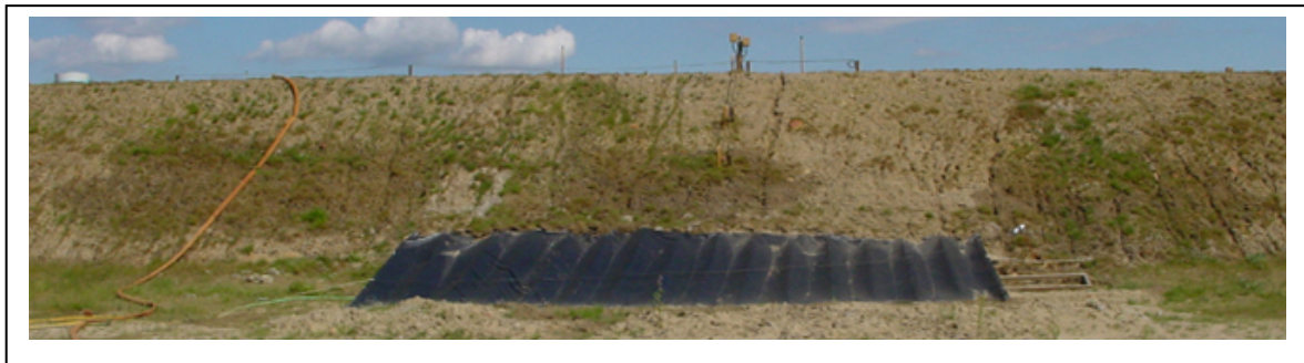
Abb. 241 : Fortschreitende Vernässung des homogenen Abschnitts nach 10 Tagen Volleinstau
