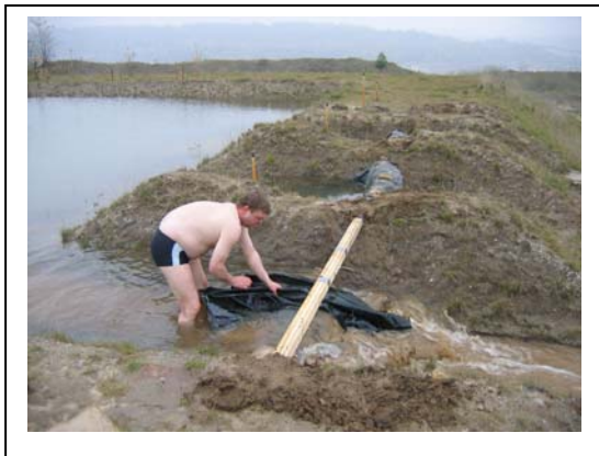
Abb. 300 : Beseitigung des Sandsackwalls für den Überströmversuch an der Überlaufstrecke Var. 3.1 mit 40 cm Überstau
