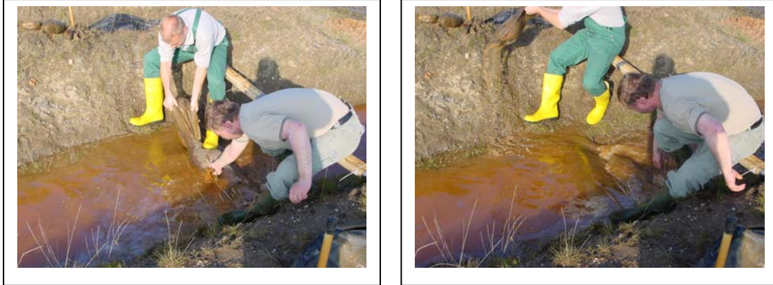
Abb. 297 : Beseitigung des Sandsackwalls für den Überströmversuch an der Überlaufstrecke Var. 3.1 mit 20 cm Überstau
