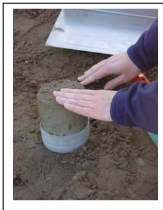
Abb. 135 : Entnahme der Erdstoffproben mittels Ausstechzylinder für die Dichtebestimmung
