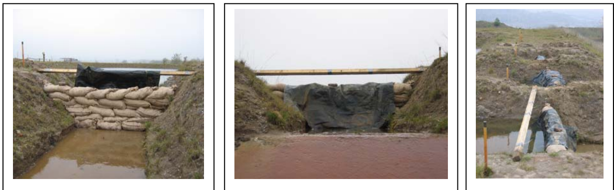
Abb. 296 : Sandsackwall für den Überstau von 40 cm der 2. Versuchsreihe
