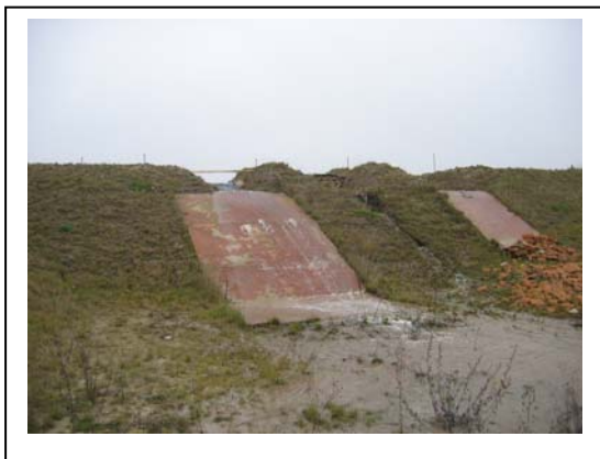
Abb. 307 : Landseitige Böschung nach Überströmung der Überlaufstrecke Var. 3.3 mit 20 cm Überstau
