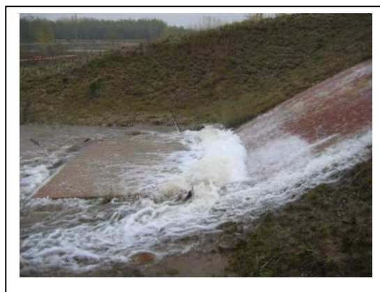
Abb. 301 : Überströmung der Überlaufstrecke Var. 3.1 mit 40 cm Überstau
