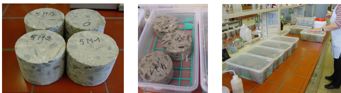
Abb. 42 : Prüfkörper und Versuchsanordnung der Untersuchungen zum Säurewiderstand
