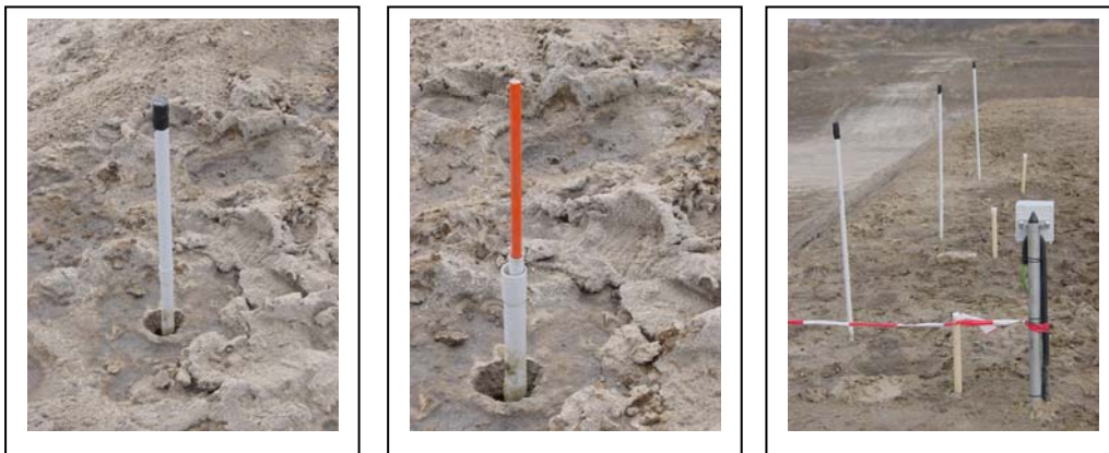
Abb. 172 : Stangenextensometer für die Setzungsmessung im Erdkörper
