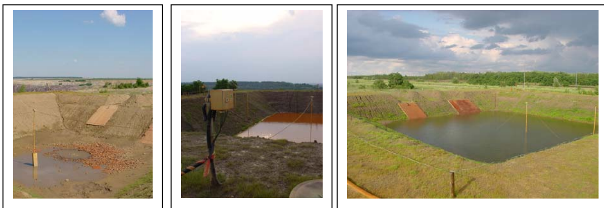
Abb. 197 : Ersteinstau auf 1 m Wasserstand (0. Messkampagne) vom 11.06.2007
