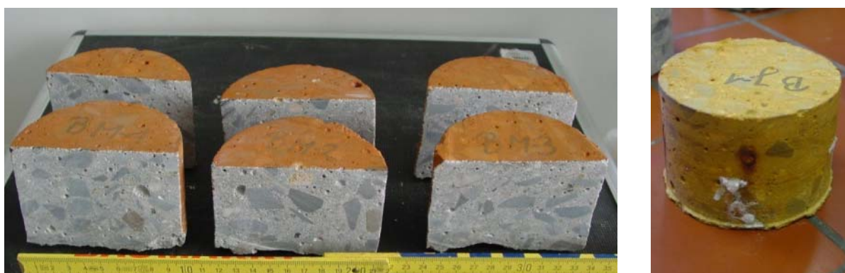
Abb. 47 : Geschnittene Prüfkörper (li.), Auskristallisationen am Prüfkörper (re.)
