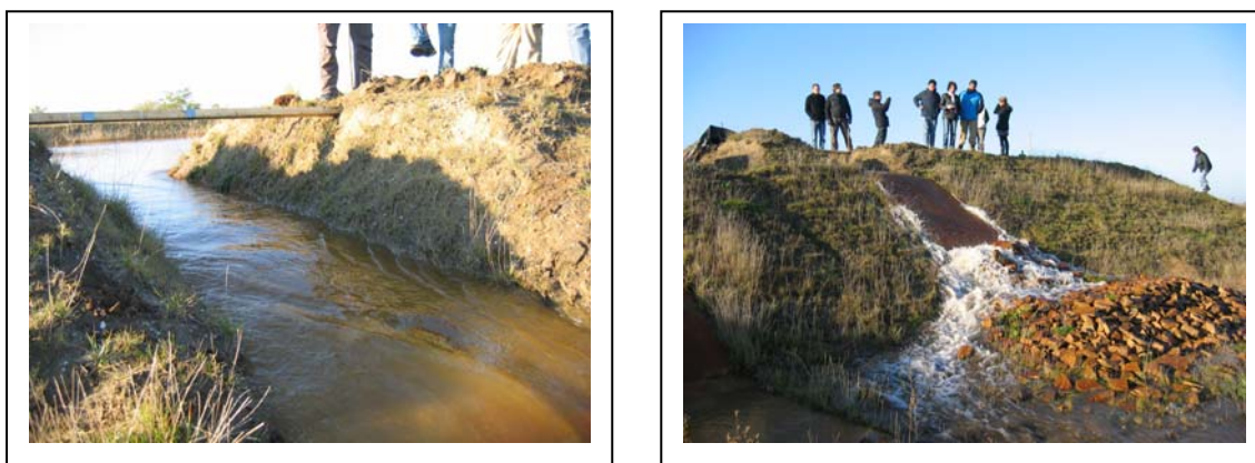
Abb. 304 : Überströmung der Überlaufstrecke Var. 3.2 mit 20 cm Überstau
