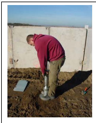
Abb. 135 : Entnahme der Erdstoffproben mittels Ausstechzylinder für die Dichtebestimmung
