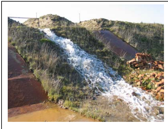
Abb. 306 : Überströmung der Überlaufstrecke Var. 3.3 mit 20 cm Überstau
