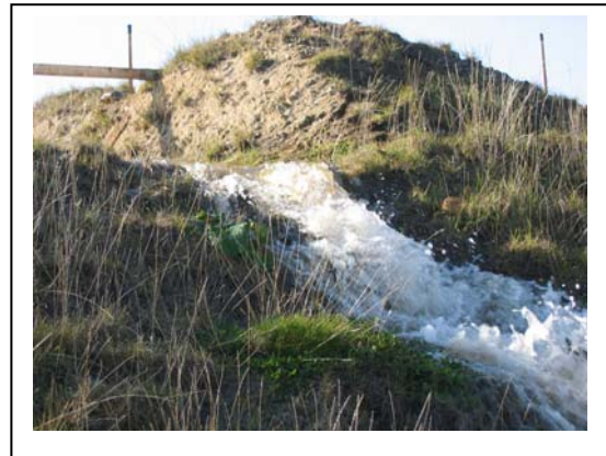
Abb. 306 : Überströmung der Überlaufstrecke Var. 3.3 mit 20 cm Überstau
