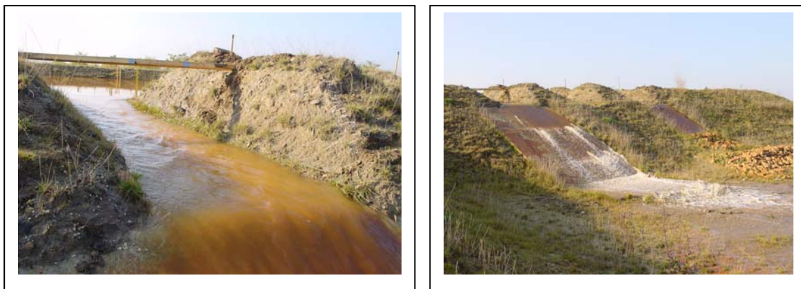
Abb. 298 : Überströmung der Überlaufstrecke Var. 3.1 mit 20 cm Überstau
