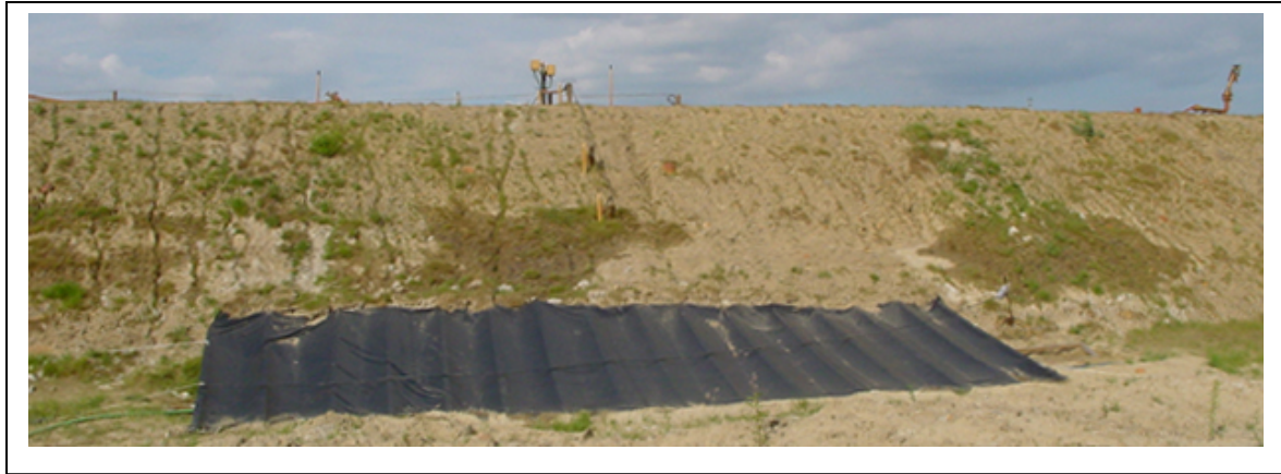
Abb. 240 : Beginnende Vernässung des homogenen Abschnitts nach 8 Tagen Volleinstau
