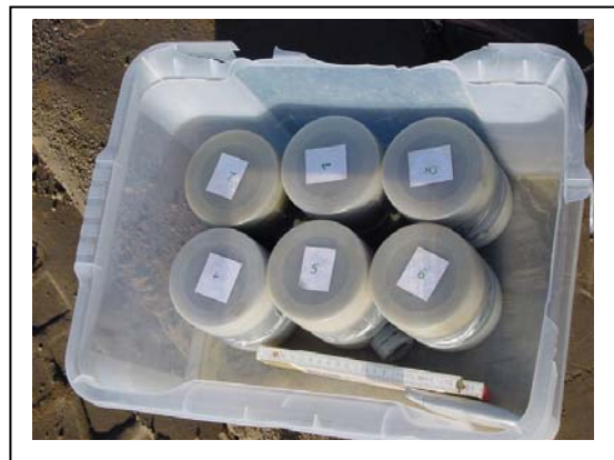
Abb. 135 : Entnahme der Erdstoffproben mittels Ausstechzylinder für die Dichtebestimmung
