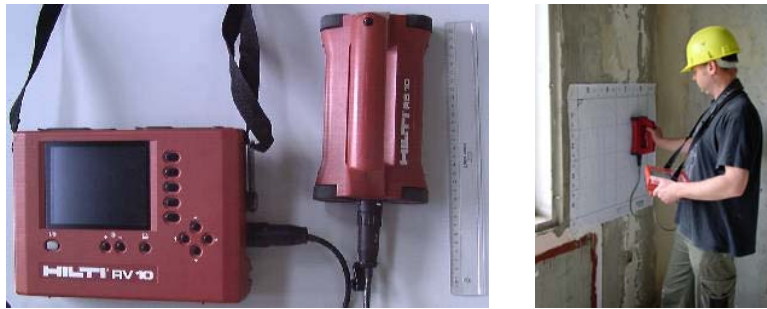
Abb. 47 : Hilti-Ferrosan-System FS 10 zur Ermittlung der Betondeckung
