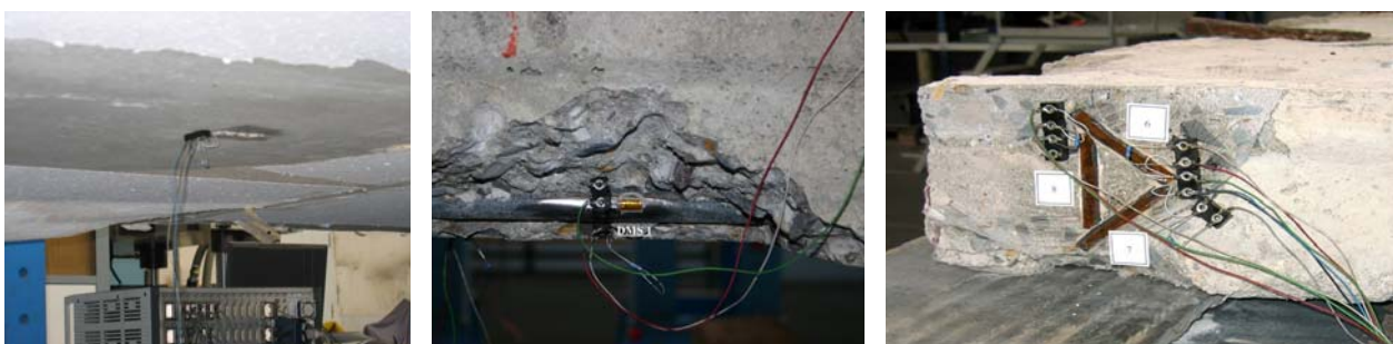
Abb. 56 : Dehnmessstreifen in der Zugzone (li.); freigelegter Bereich zur Ermittlung der Dehnung des Spannstahls unter Lasteinwirkung (mi.); Messung der Querkraftspannung (re.)
