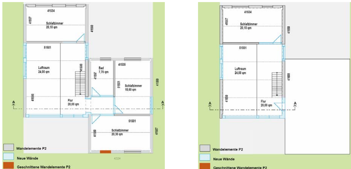
Abb. 141 : Grundrisse des Einfamilienhauses Obergeschoss - Variante 1 und 2 (v.l.n.r.)
