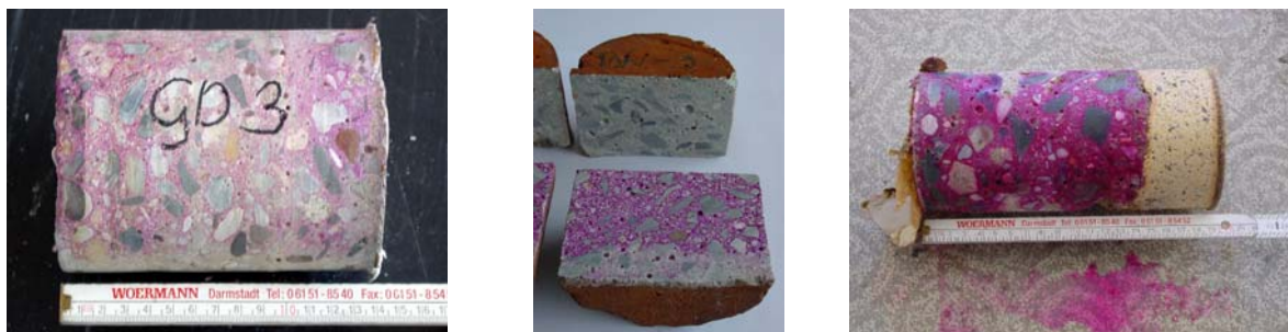
Abb. 39 : Darstellung eines Bohrkerns (Deckenelement WBS 70, Dresden) nach der Bestimmung der Karbonatisierungstiefe – hier: alkalische (unversehrte) Bereiche mit violetter Verfärbung
