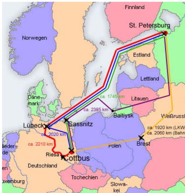
Abb. 101 : Transportwege und –varianten für einen Bauteiltransport nach St. Petersburg 327
