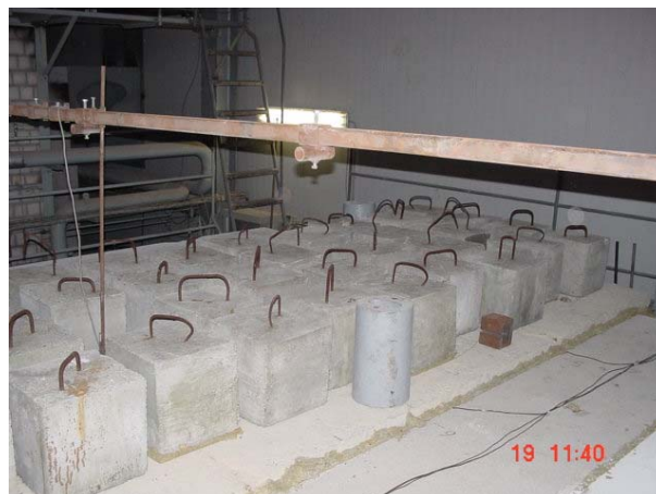
Abb. 71 : Brandraum (li.) und Simulation Belastung (re.)
