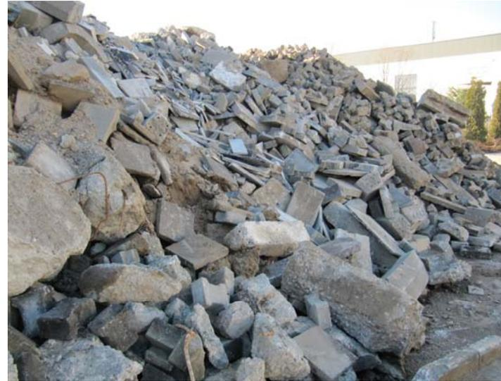
**Selektiv angelieferter und auf der RC-Anlage gelagerter Betonbruch**
